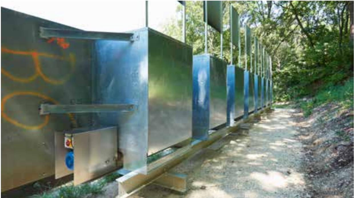
*Abb. 53: Kugelfangsystem von hinten Berin mit Austragungssystem*
